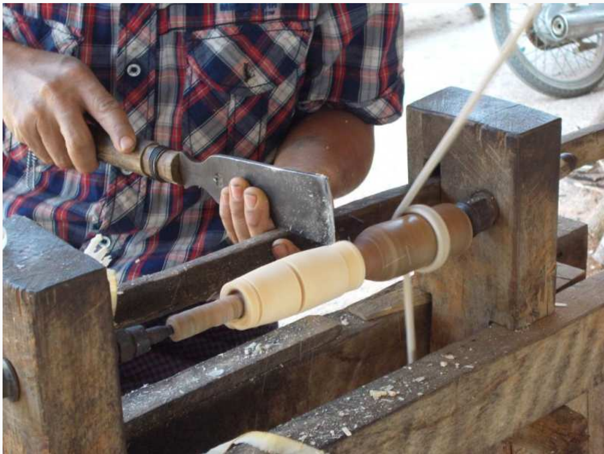
Drechselarbeiten für die Holzteile
