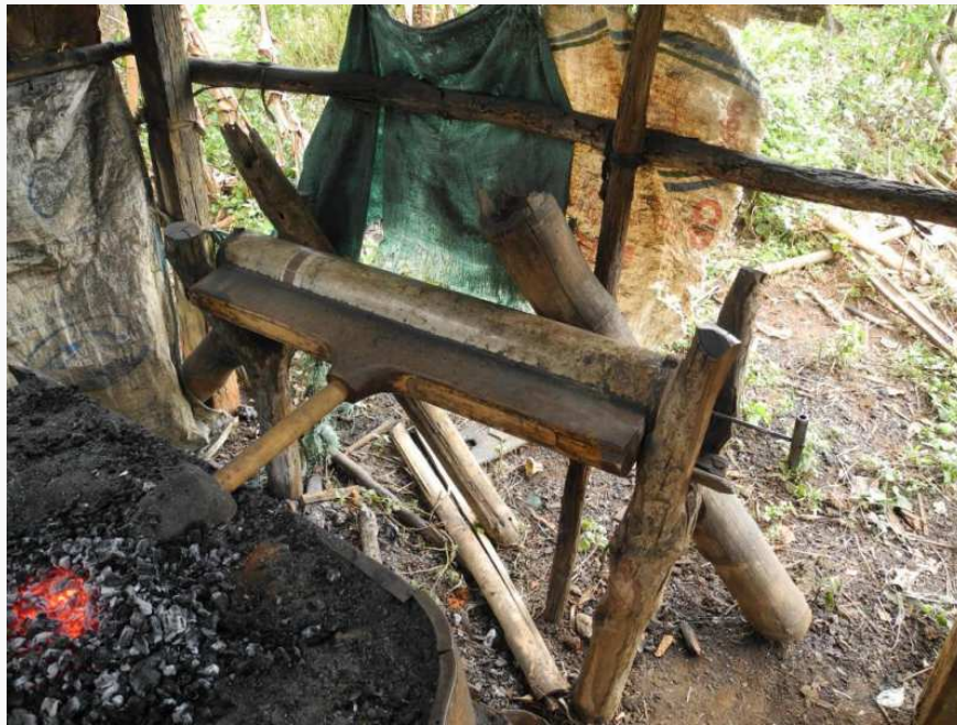
Blasbalg aus Teil von einem Leuchtfallschirm
