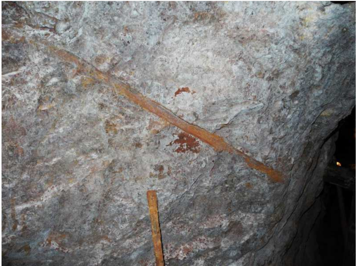
Bohrloch, in das dann der Sprengstoff eingefüllt wurde
