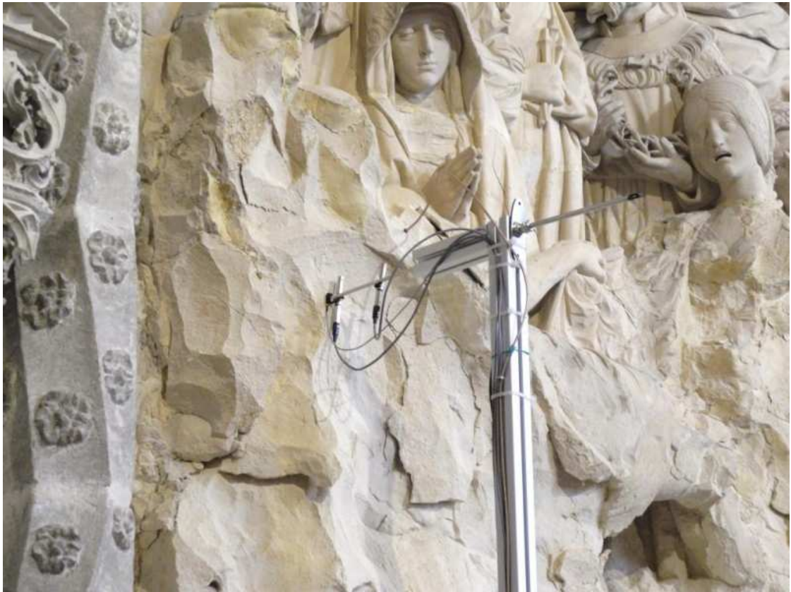
Vor der Restaurierung wird der Sandstein analysiert
