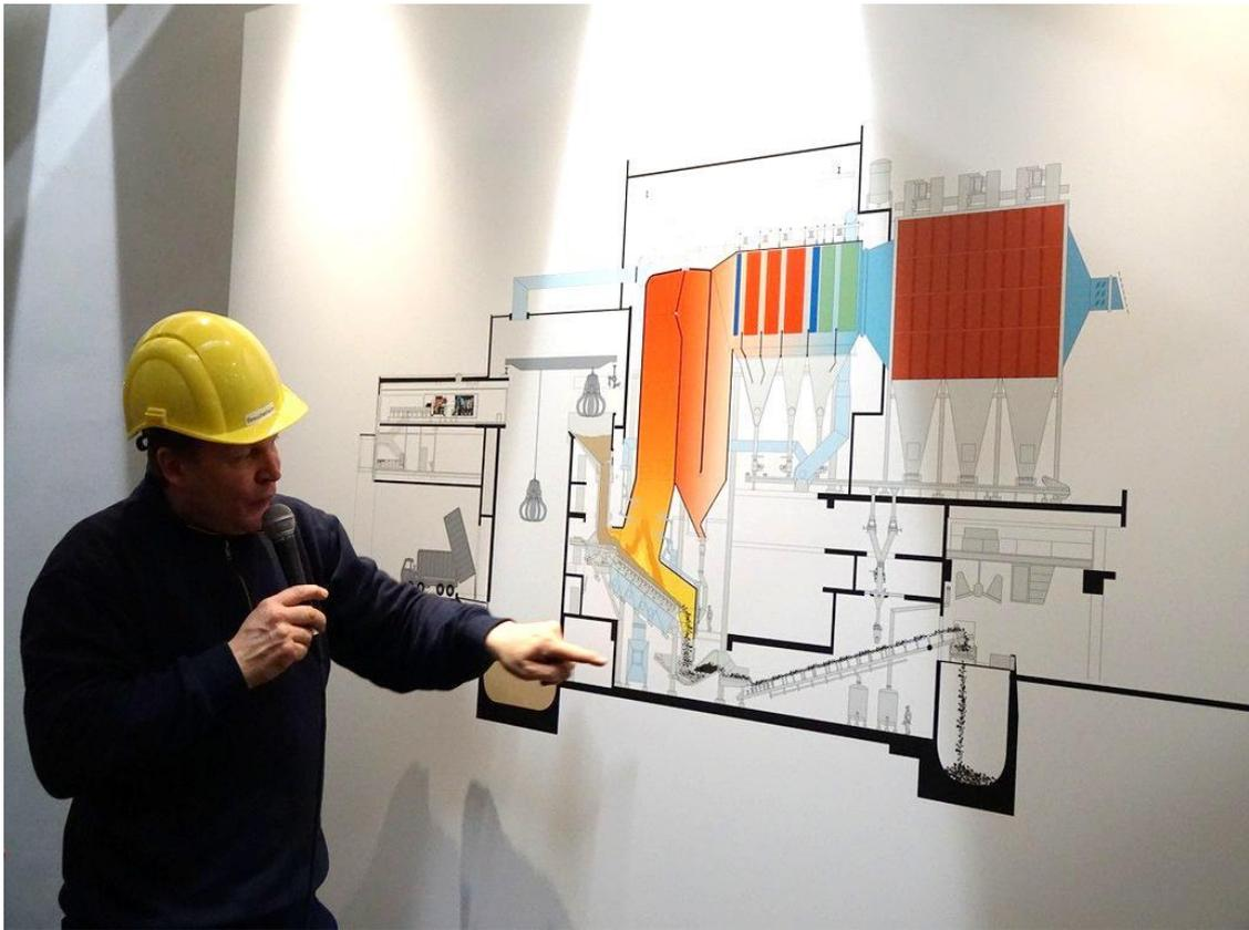
Zwischendurch wieder einmal Erklärungen und Orientierungshilfen. Links Bunker, gelbrot Verbrennung, rot Dampfkessel, dunkelrot Elektrofilter, unten Schlackenabtransport
