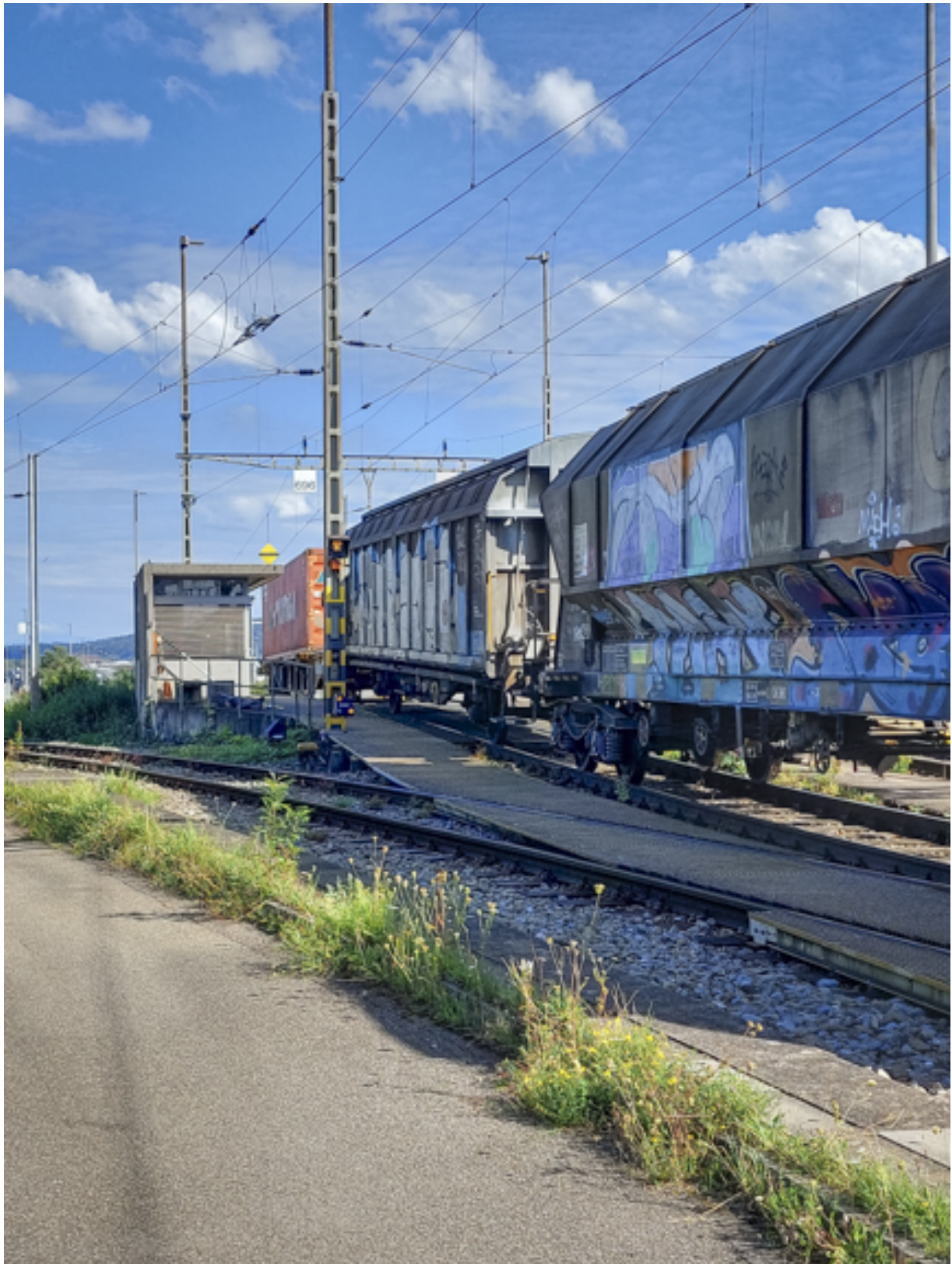
Die entkoppelten Wagen rollen mit gelösten Bremsen einzeln den Berg hinunter
