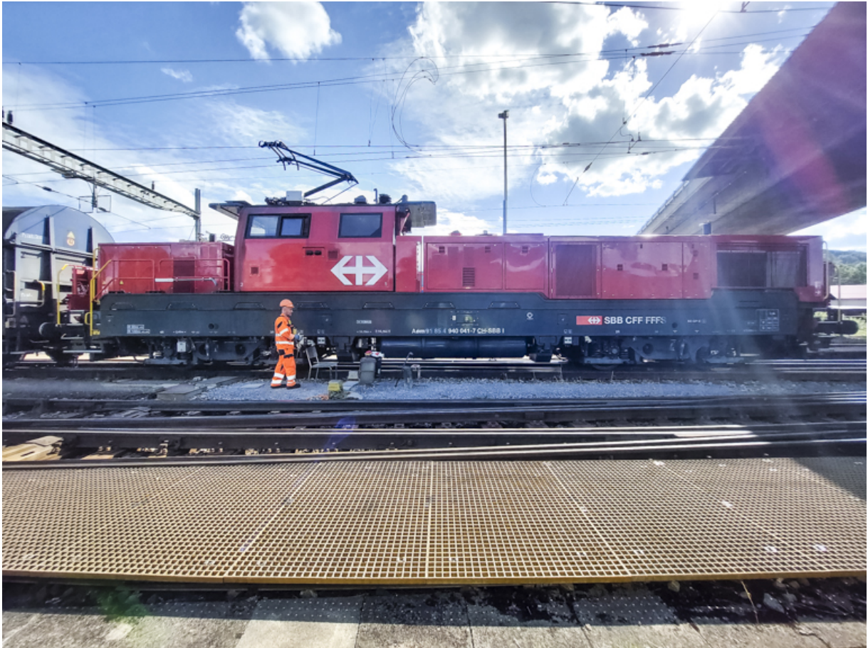
Die neuen hybriden Rangierlokomotiven (Diesel- und Elektroantrieb), die die Wagen über den Ablaufberg schieben
