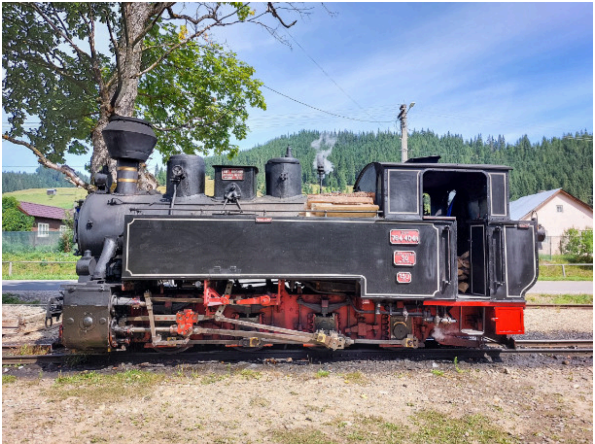
Es ist eine 150-PS-Dampflok aus dem rumänischen Reghin (Modell Resița) im Einsatz.
