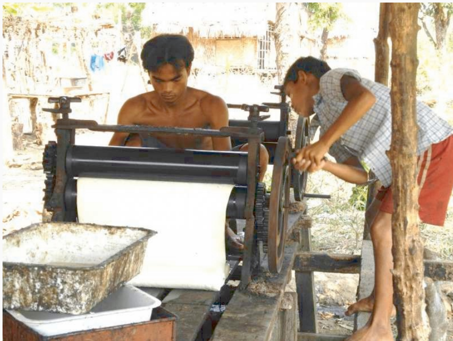
Die Masse wird in mehreren Durchgängen ausgewalzt
