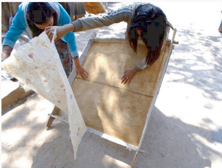
Das Papier ist geschöpft, getrocknet und wird abgelöst
