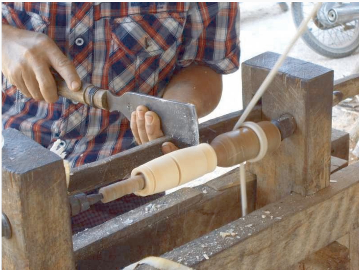
Drechselarbeiten für die Holzteile
