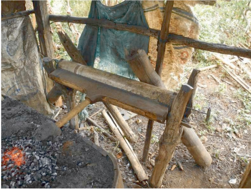
Blasbalg aus Teil von einem Leuchtfallschirm
