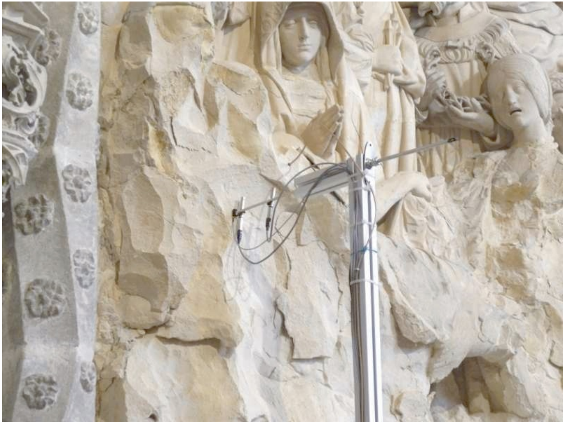
Vor der Restaurierung wird der Sandstein analysiert
