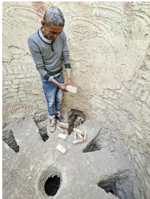
Im Ofen werden die Rohziegel nach dem Trocknen nach einem ausgeklügelten System aufge- schichtet und bei 900° gebrannt
